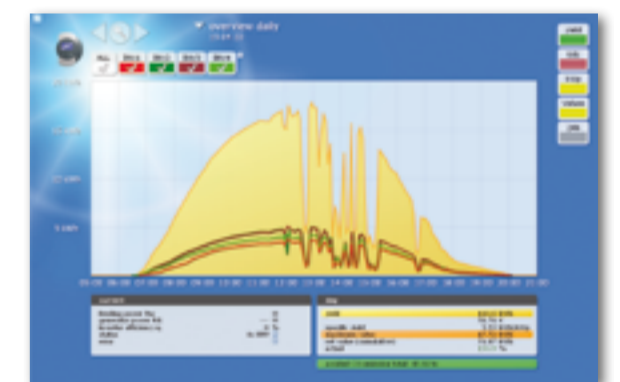
Tagesübersicht mit 4 Wechselrichtern und Verschattung Daily overview with 4 inverters and overcast
